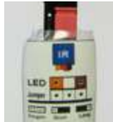
Steckbrücke rechts: kurze Reichweite
