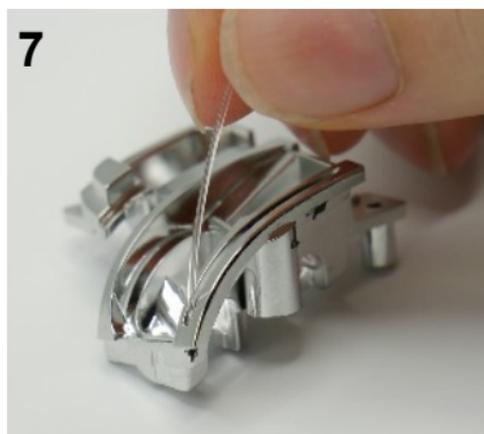
des Scheinwerfers in den Blinkerschlitze einkleben. Dabei darauf achten, dass das geklebte Ende nicht übersteht.
